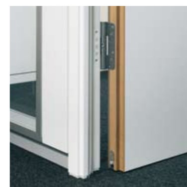
Element: Holz-Türelement H65 Türzarge: Doppelfalz zarge 35/50/15 beschichtet weiß Türblatt: Holz-Türblatt 65 mm in Schichtstoff weiß Prüfwert: R_{w,p} = 42 dB, optional 47 dB (H70-4) Oberteil: Verglasung fecolux in Alu natur eloxiert Seitenteile: Vollwand fecowand in Melamin weiß
