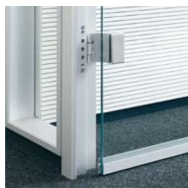
Element: Glas-Türelement G10 mit raumhohem Glas-Türblatt Türzarge: Aluzarge 18/50 in Alu natur eloxiert Türblatt: Glas-Türblatt 10 mm ESG klar Prüfwert: R_{w,p} = 32 dB (Serienhöhe) Seitenteil: Verglasung fecofix in Alu natur eloxiert
