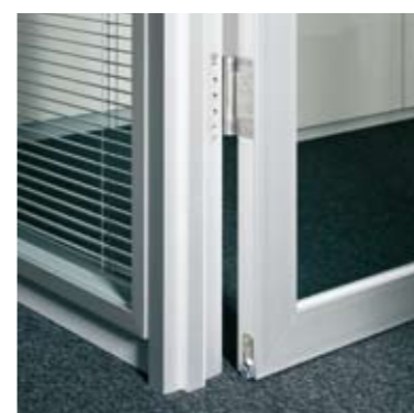
Element: Alurahmen-Türelement A40 Türzarge: Aluzarge 35/35 in Alu natur eloxiert Türblatt: Rahmen-Türblatt 40 mm in Alu natur eloxiert Prüfwert: R_{w,p} = 32 dB, optional 35 dB oder 37 dB Oberteil: Verglasung fecolux in Alu natur eloxiert Seitenteil: Verglasung fecolux in Alu natur eloxiert
