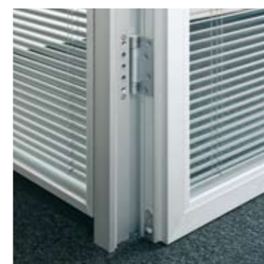
Element: Glas-Türelement fecofix A60 Türzarge: Aluzarge 18/50 in Alu natur eloxiert Türblatt: Rahmen-Türblatt fecofix 60 mm in Alu eloxiert mit integrierter Horizontaljalousie Prüfwert: R_{w,p} = 35 dB, optional 37 dB oder 42 dB (A65) Seitenteil: Verglasung fecofix in Alu natur eloxiert
