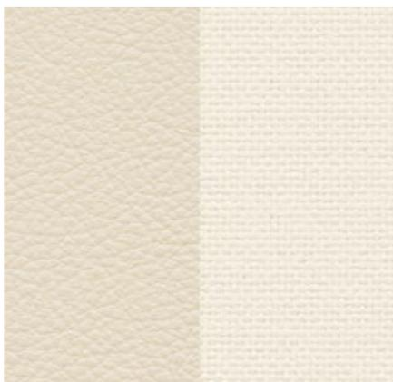
Leder Premium F ist ein eher glattes Rindleder mit flachem Narbenbild und leichtem Kuppenglanz. Es ist durchgefärbt und leicht pigmentiert. Für seine Herstellung wird ein Gerbstoff verwendet, der aus Olivenbaumblättern (Abfallprodukt der Olivenernte) gewonnen wird. Leder Premium F ist in 22 Farben erhältlich.
