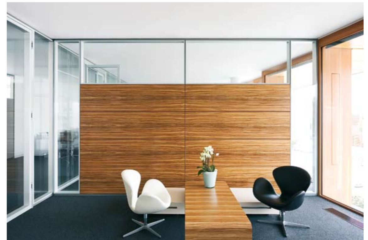
Flurwand: fecostruct Doppelverglasung Türelement: fecostruct Doppelverglasung S105 Raster Flur: B x H = 1,35 x 3,00 m Bürowand: fecowand in Zebrano natur mit fecostruct Doppelverglasung Raster Büro: B x H = 0,50/2,00 x 3,00 m Projekt: feco I forum, Karlsruhe
