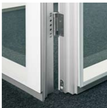
Element: Glas-Türelement fecostruct S105 Türzarge: Aluzarge 35/0 in Alu natur eloxiert, flurseitig verdeckt liegend Türblatt: Glas-Türblatt fecostruct 105 mm in Alu eloxiert Prüfwert: R_{w,p} = 37 dB, optional 42 dB Seitenteil: Verglasung fecostruct in Alu natur eloxiert
