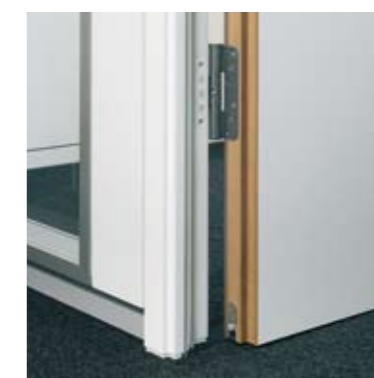
Element: Holz-Türelement H65 Türzarge: Doppelfalz zarge 35/50/15 beschichtet weiß Türblatt: Holz-Türblatt 65 mm in Schichtstoff weiß Prüfwert: R_{w,p} = 42 dB, optional 47 dB (H70-4) Oberteil: Verglasung fecolux in Alu natur eloxiert Seitenteil: Vollwand fecowand in Melamin weiß
