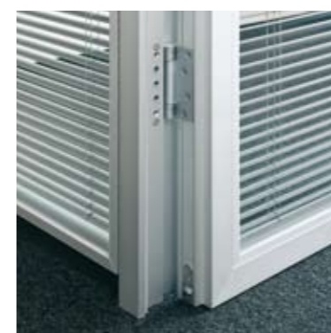
Element: Glas-Türelement fecofix A60 Türzarge: Aluzarge 18/50 in Alu natur eloxiert Türblatt: Rahmen-Türblatt fecofix 60 mm in Alu eloxiert mit integrierter Horizontaljalousie Prüfwert: R_{w,p} = 35 dB, optional 37 dB oder 42 dB (A65) Seitenteil: Verglasung fecofix in Alu natur eloxiert
