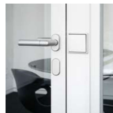
Element: Glas-Türelement fecoplan S60 Türzarge: Aluzarge 35/50T60 in Alu natur eloxiert Türblatt: Glas-Türblatt fecostruct 60 mm in Alu eloxiert Prüfwert: R_{w,p} = 32 dB, optional 37 dB (doppelverglast) Seitenteil: fecoplan zargenintegriert in Alu natur eloxiert Glaswand: Verglasung fecoplan in Alu natur eloxiert
